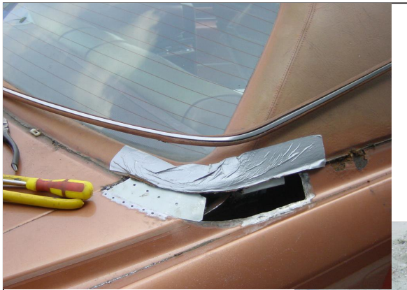
Foto 11b: Roest wegslijpen en stukjes inlassen.
