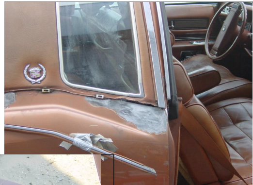
Foto 11d: Stuk ingelast bij het zijraampje.
