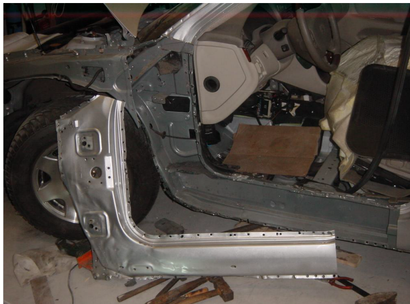
Foto 8: Dorpel demontage waarvoor een paar honderd puntlassen moesten worden doorboord.
